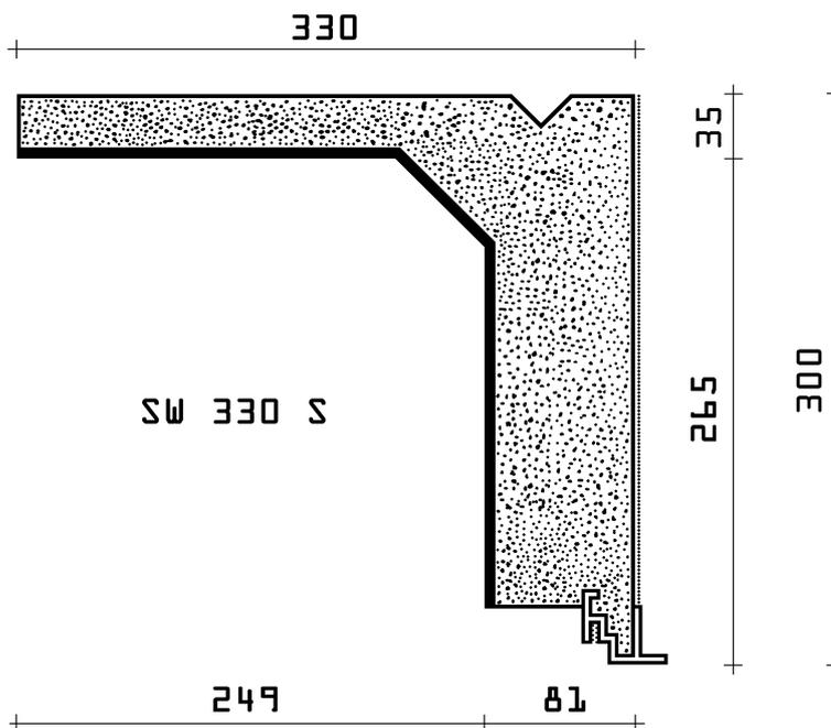
Serienmäßig haben alle Rolladenkästen der Typenreihe SW eine spezielle **Clip - Innenschiene** für den einfachen, schraublosen **EASY - CLIP - Deckelanschluss**, mit 15 mm Ausladung.
